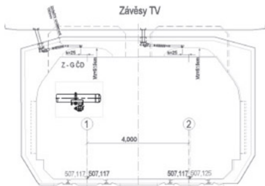
Obrázek 4 Zavěšení trakčního vedení pod žebry
