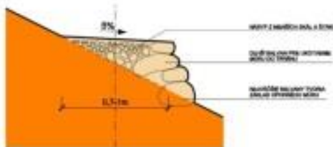
Obrázok 3 Násyp s opornou stenou Zdroj: vlastné spracovanie
